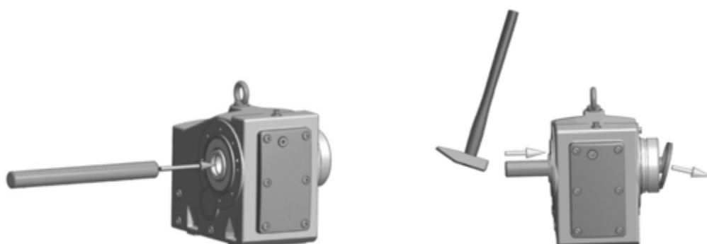
Рис. 6: Извлечение установленных на заводе заглушек
